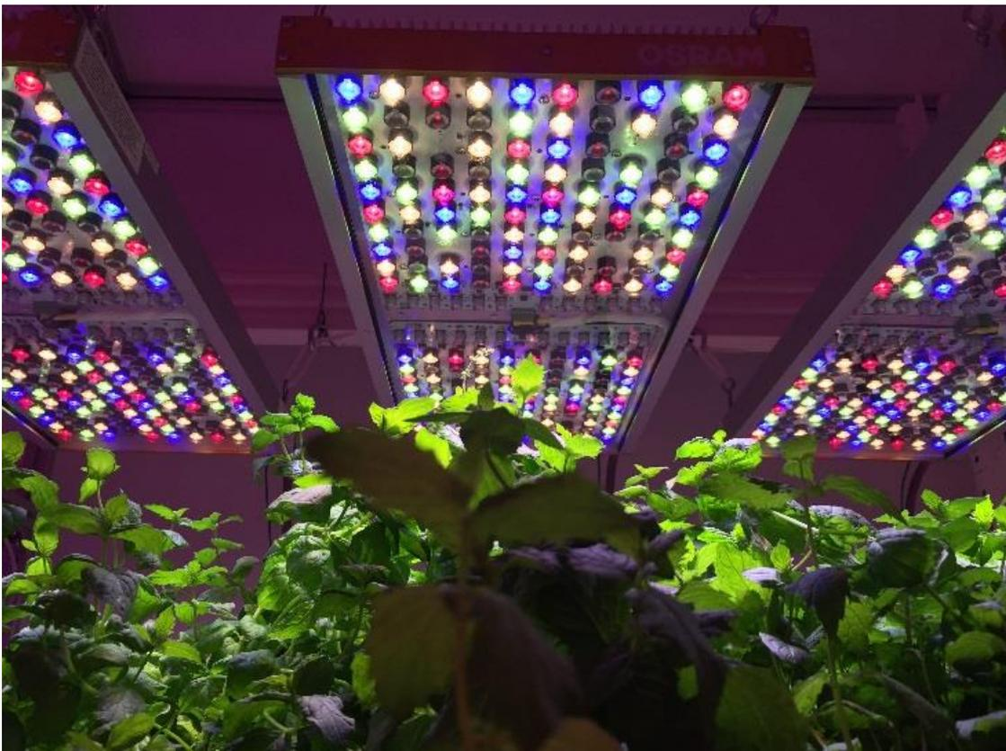
Bei Phytofy RL kann jeder der sechs Spektralkanäle einzeln adressiert und die Intensität in Echtzeit genau geplant und kontrolliert werden.
