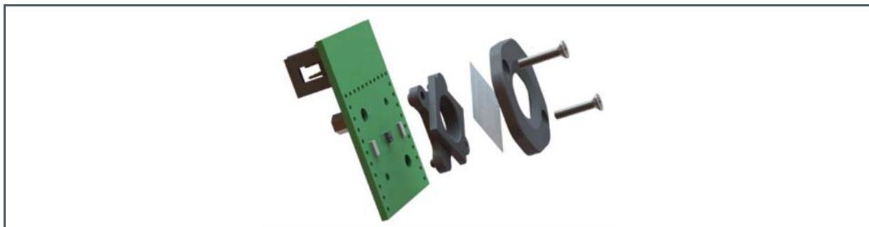
Figure 19: Installation of Diffuser Holder ALS (1)
